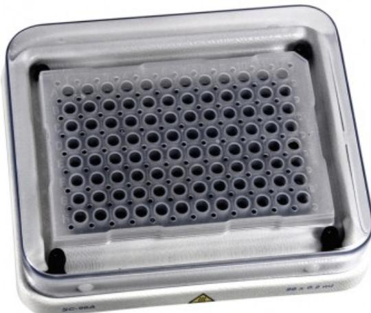
Blocco per 1 micropiastra a 96 pozetti per PCR (volume pozzetti di 0,2 ml).
