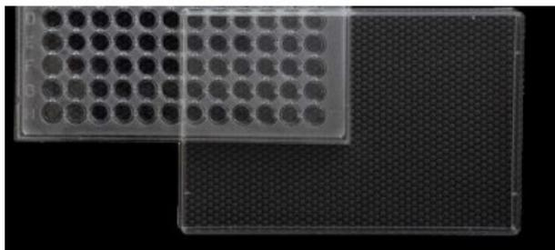
Coperchi per piastre microtiter 96 pozzetti non sterili conf. 50 pezzi
